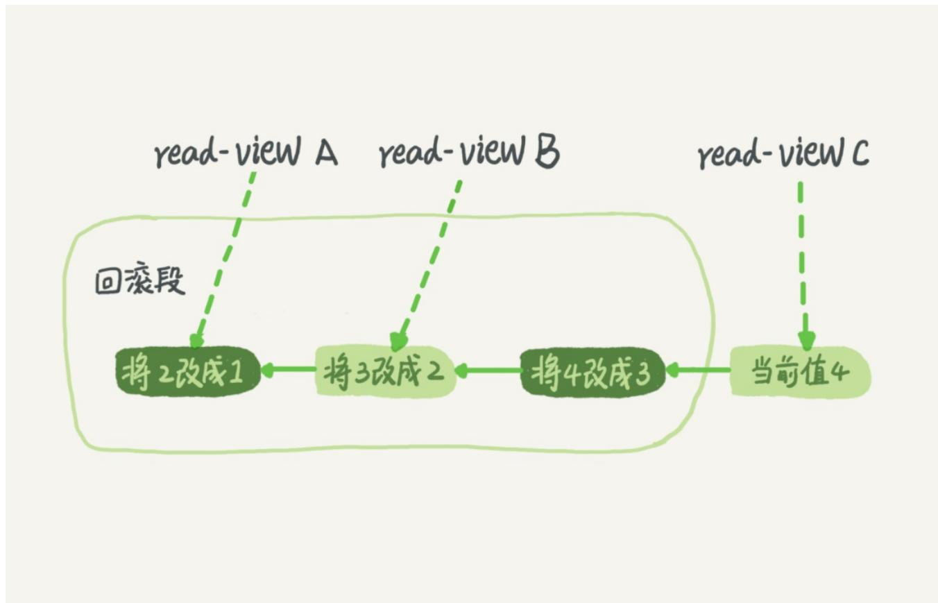
当前值是4，但是在查询这条记录的时候，不同时刻启动的事务会有不同的read-view。如图中看到的，在视图A、B、C里面，这一个记录的值分别是1、2、4，同一条记录在系统中可以存在多个版本，就是数据库的多版本并发控制（MVCC）。对于read-view A，要得到1，就必须将当前值依次执行图中所有的回滚操作得到。
