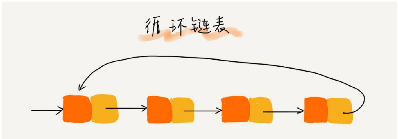
和单链表相比，**循环链表**的优点是从链尾到链头比较方便。当要处理的数据具有环型结构特点时，就特别适合采用循环链表。比如著名的[约瑟夫问题](#)。尽管用单链表也可以实现，但是用循环链表实现的话，代码就会简洁很多。
