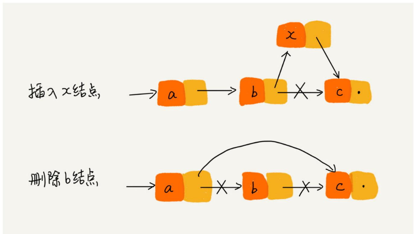
但是，有利就有弊。链表要想随机访问第  $k$  个元素，就没有数组那么高效了。因为链表中的数据并非连续存储的，所以无法像数组那样，根据首地址和下标，通过寻址公式就能直接计算出对应的内存地址，而是需要根据指针一个结点一个结点地依次遍历，直到找到相应的结点。
