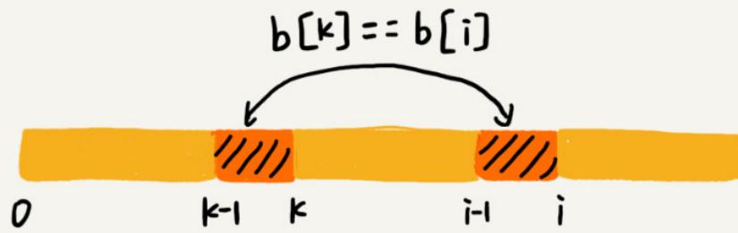
我们假设  $b[0, i]$  的最长可匹配后缀子串是  $b[r, i]$ 。如果我们把最后一个字符去掉，那  $b[r, i-1]$  肯定是  $b[0, i-1]$  的可匹配后缀子串，但不一定是最长可匹配后缀子串。所以，既然  $b[0, i-1]$  最长可匹配后缀子串对应的模式串的前缀子串的下一个字符并不等于  $b[i]$ ，那么我们就可以考察  $b[0, i-1]$  的次长可匹配后缀子串  $b[x, i-1]$  对应的可匹配前缀子串  $b[0, i-1-x]$  的下一个字符  $b[i-x]$  是否等于  $b[i]$ 。如果等于，那  $b[x, i]$  就是  $b[0, i]$  的最长可匹配后缀子串。
