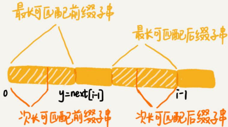
按照这个思路，我们可以考察完所有的  $b[0, i-1]$  的可匹配后缀子串  $b[y, i-1]$ ，直到找到一个可匹配的后缀子串，它对应的前缀子串的下一个字符等于  $b[i]$ ，那这个  $b[y, i]$  就是  $b[0, i]$  的最长可匹配后缀子串。
