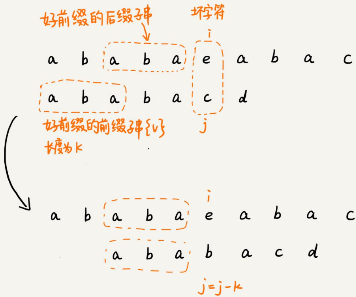
为了表述起来方便，我把好前缀的所有后缀子串中，最长的可匹配前缀子串的那个后缀子串，叫作**最长可匹配后缀子串**；对应的前缀子串，叫作**最长可匹配前缀子串**。
