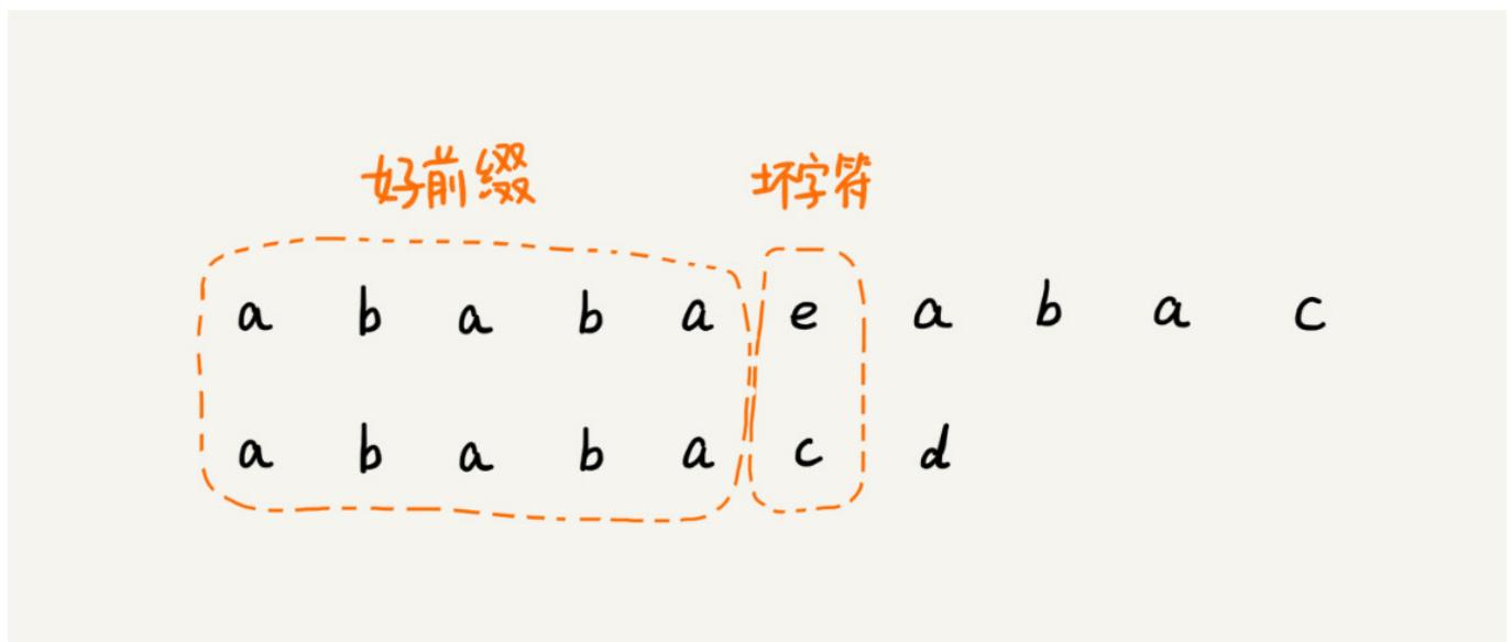
当遇到坏字符的时候，我们就要把模式串往后滑动，在滑动的过程中，只要模式串和好前缀有上下重合，前面几个字符的比较，就相当于拿好前缀的后缀子串，跟模式串的前缀子串在比较。这个比较的过程能否更高效了呢？可以不用一个字符一个字符地比较了吗？
