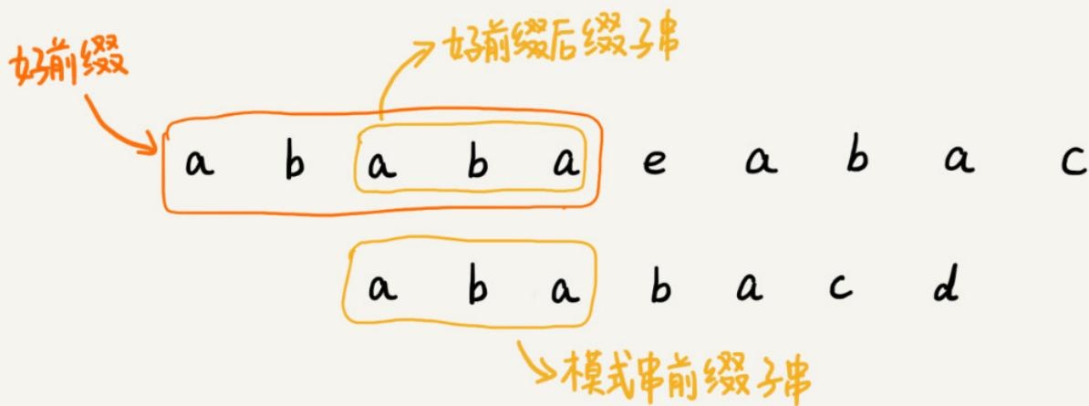
KMP 算法就是在试图寻找一种规律：在模式串和主串匹配的过程中，当遇到坏字符后，对于已经比对过的好前缀，能否找到一种规律，将模式串一次性滑动很多位？
