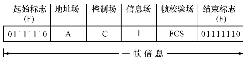
图 9.18 SDLC/HDLC 的帧格式
