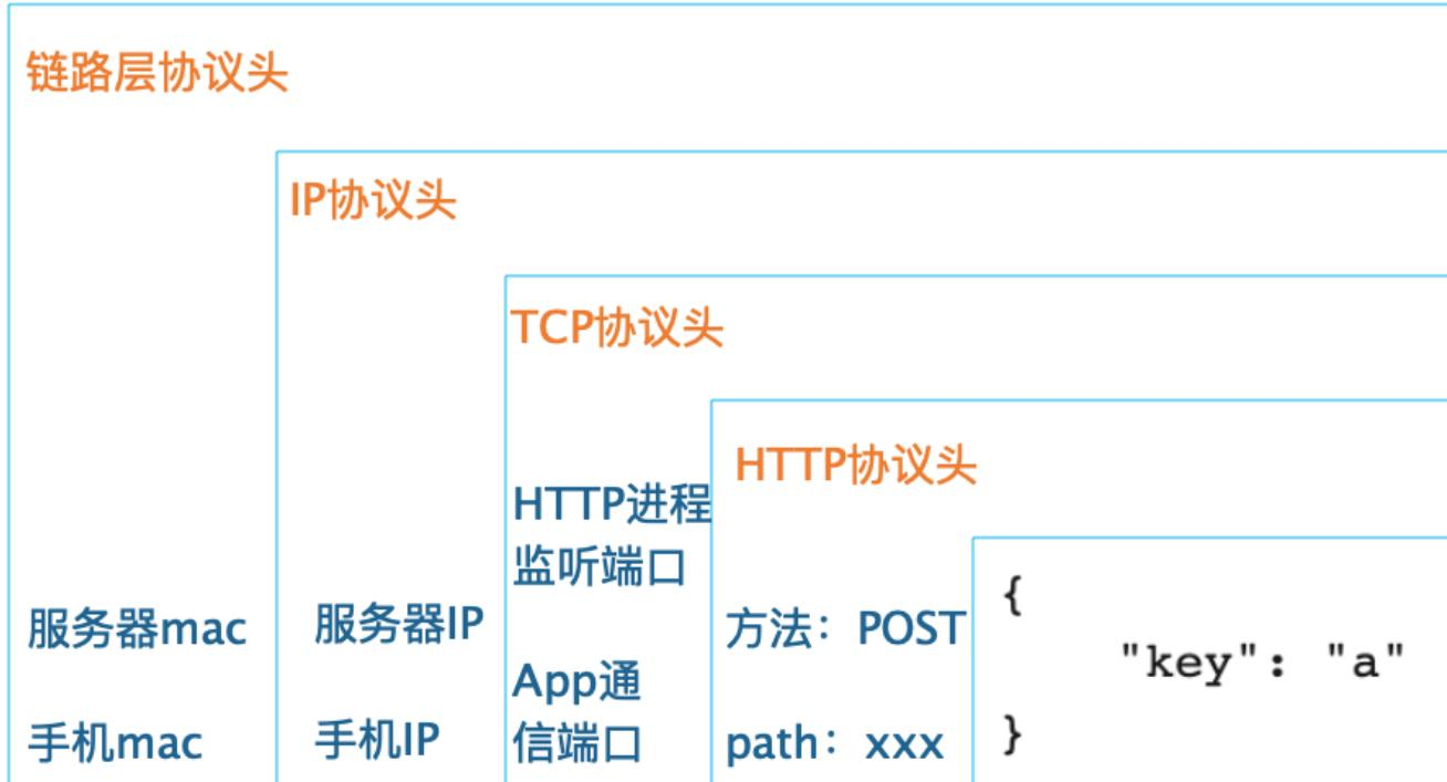
App 要发送的数据只是 `key= "a"` 这样一个 JSON 字符串，每一层协议都会在上一层协议基础上添加一个头部信息，最后封装成一个链路层的数据帧在网络上传输，发送给淘宝的服务器。淘宝的服务器在收到这个数据帧后，在通信协议的每一层进行校验检查，确保数据准确后，将头部信息删除，再交给自己的上一层协议处理。HTTP 应用服务器在最上层，负责 HTTP 协议的处理，最后将 `key= "a"` 这个 JSON 字符串交给淘宝工程师开发的应用程序处理。
