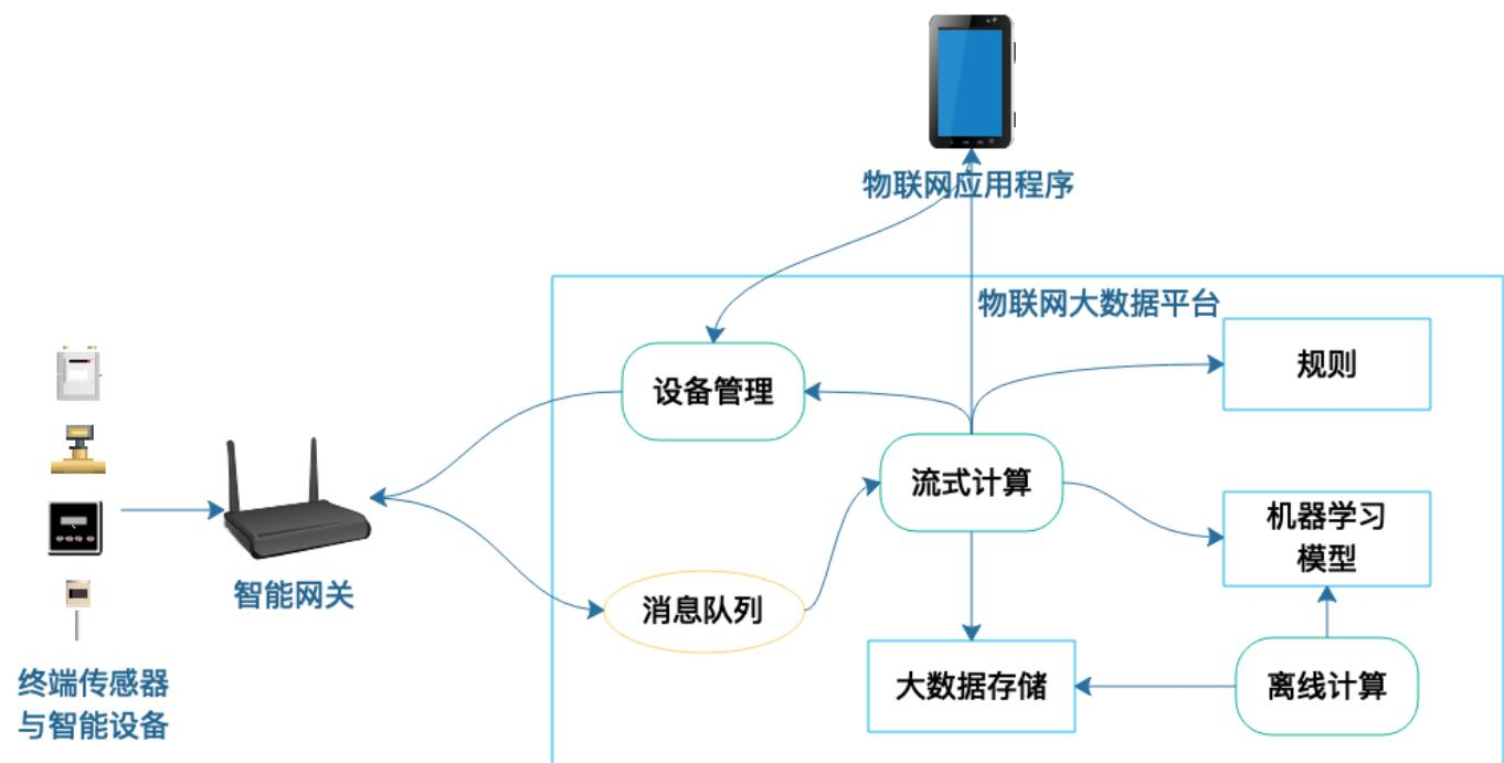
终端设备负责采集现场数据，这些数据被汇总到智能网关，智能网关经过初步的转换、计算后将数据发送给物联网大数据平台，大数据平台通过消息队列接收发送上来的各种数据。
