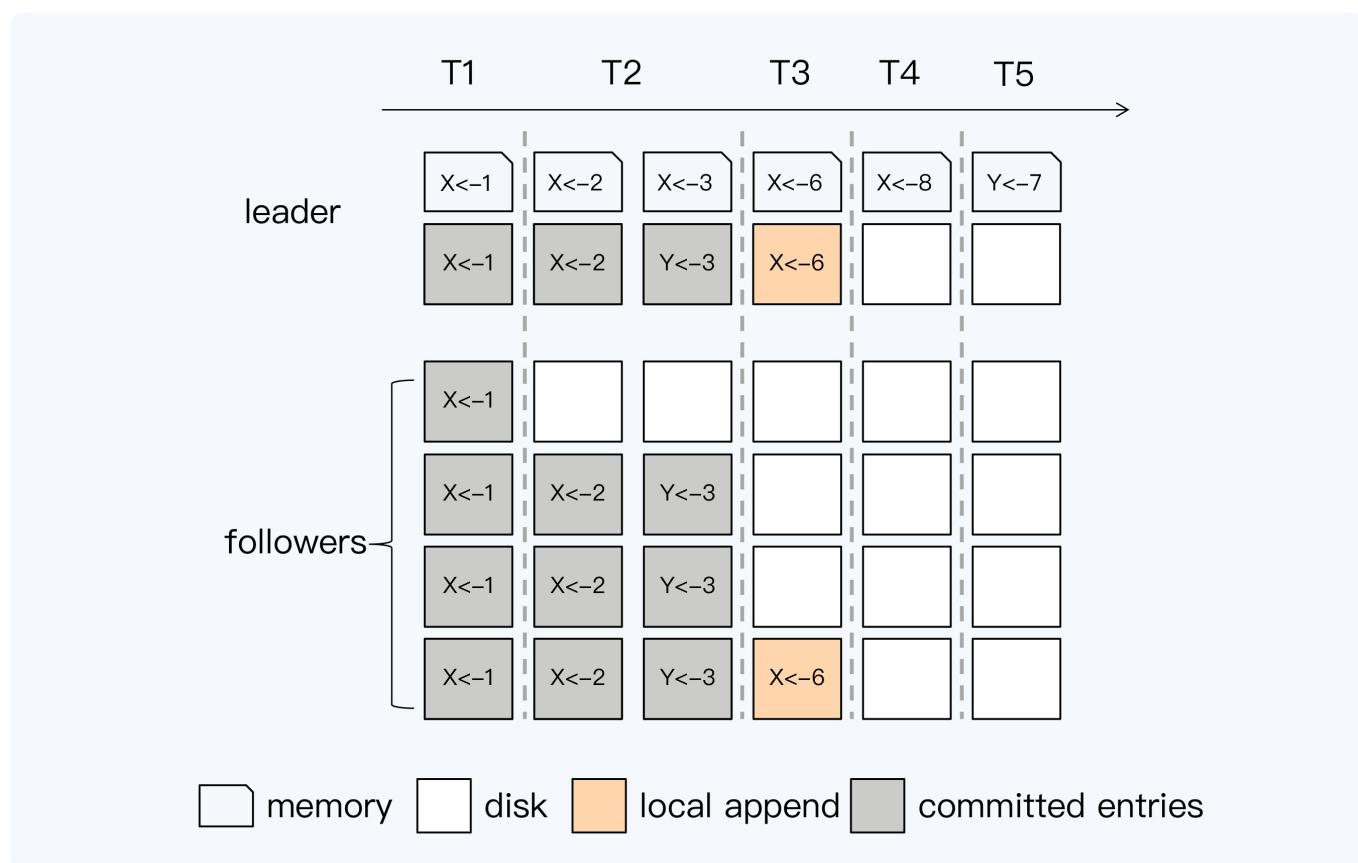
我们设定这个 Raft 组由 5 个节点组成，T1 到 T5 是先后发生的 5 个事务操作，被发送到这个 Raft 组。
