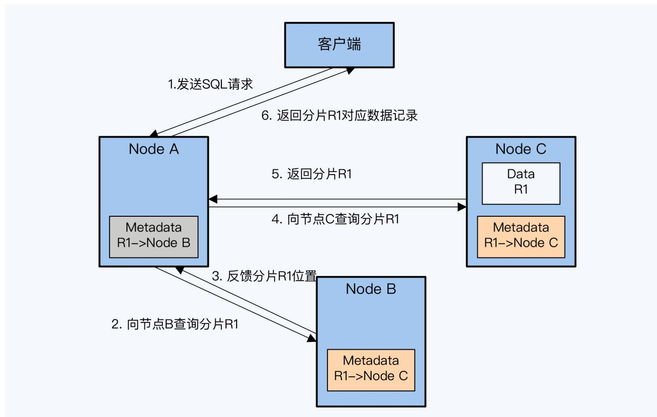
1. 节点 A 接到客户端的 SQL 请求，要查询数据表 T1 的记录，根据主键范围确定记录可能在分片 R1 上，而本地元数据显示 R1 存储在节点 B 上。
