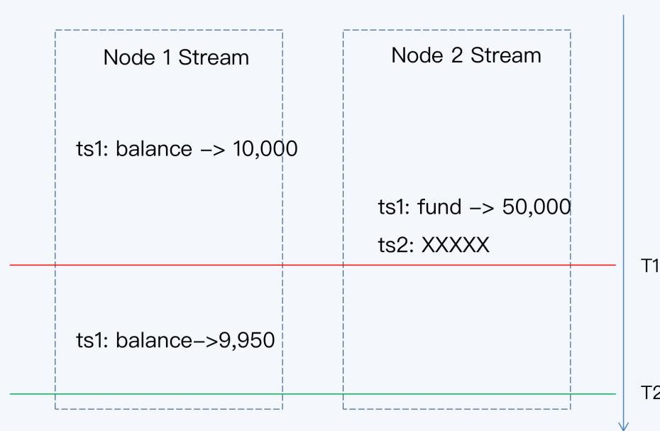
在前面的课程中我们已经介绍过，同一个事务中发生变更的数据必定拥有用相同的提交时间戳，所以使用时间戳就可以回溯同一事务内的相关操作。同时，晚提交的事务一定拥有更大的时间戳。
