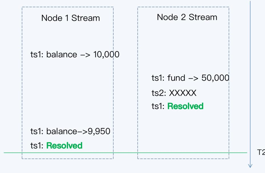
在每个节点的变更消息流中增加了 Resolved 消息后，逃生库就可以在 T2 时间判断，所有 ts1 的变更消息已经发送完毕，可以执行整个事务操作了。
