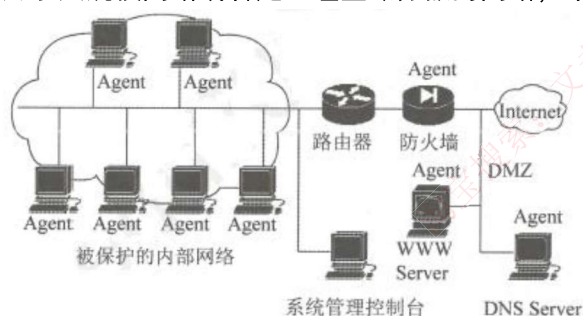
图 10-6 基于主机的入侵检测系统典型配置
