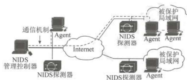
图 10-7 网络入侵检测系统功能模块的分布式配置及管理
