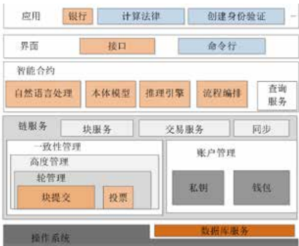
图3 北航链的架构
