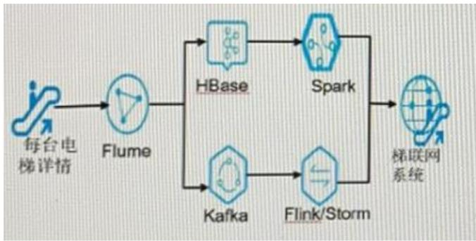
Flume 是一个分布式的、高可扩展的、高可用的将大批量的不同数据源的日志数据收、聚合、移动到数据中心(HDFS) 进行存储的系统。即是日志采集和汇总的工具
