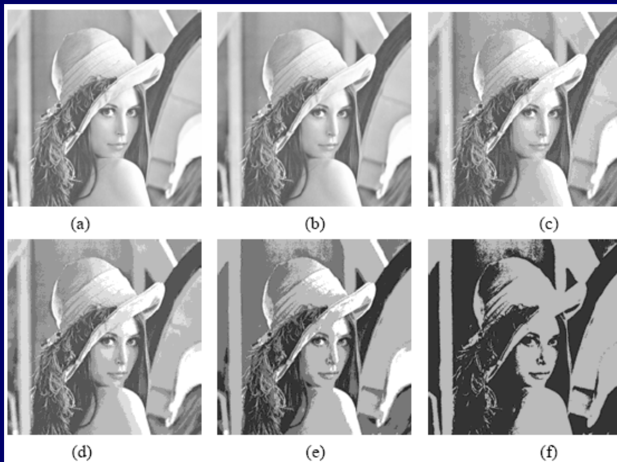
图 1.5.2 图像幅度分辨率变化所产生的效果
