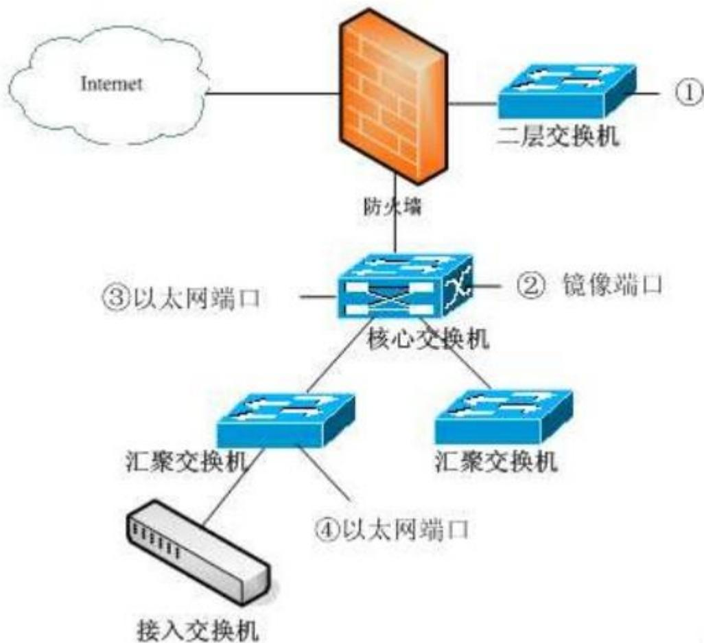
VOD 服务器应部署在位置 (16), Web 服务器应部署在位置 (17), 流量监控服务器应部署在位置 (18)。
