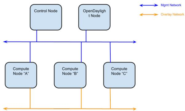
简单环境可以由一个 Openstack Control Node, 一个 Openstack Compute Node 和一个 OpenDaylight Node 组成。
