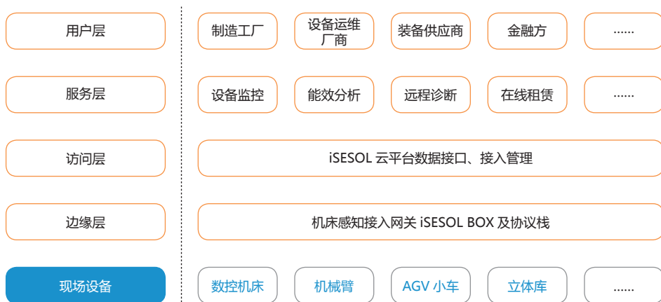
图8 iSESOL云平台架构
