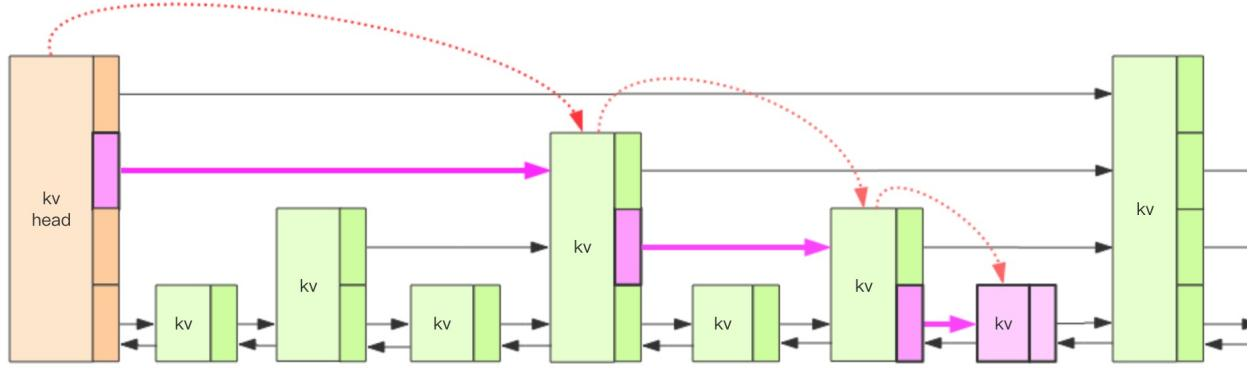
如图所示，我们要定位到那个紫色的 kv，需要从 header 的最高层开始遍历找到第一个节点（最后一个比「我」小的元素），然后从这个节点开始降一层再遍历找到第二个节点（最后一个比「我」小的元素），然后一直降到最底层进行遍历就找到了期望的节点（最底层的最后一个比我「小」的元素）。
