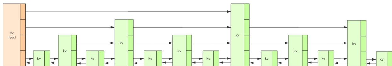
上图就是跳跃列表的示意图，图中只画了四层，Redis 的跳跃表共有 64 层，容纳  $2^{64}$  个元素应该不成问题。每一个 kv 块对应的结构如下面的代码中的 zslnode 结构，kv header 也是这个结构，只不过 value 字段是 null 值——无效的，score 是 Double.MIN\_VALUE，用来垫底的。kv 之间使用指针串起来形成了双向链表结构，它们是 **有序** 排列的，从小到大。不同的 kv 层高可能不一样，层数越高的 kv 越少。同一层的 kv 会使用指针串起来。每一个层元素的遍历都是从 kv header 出发。
