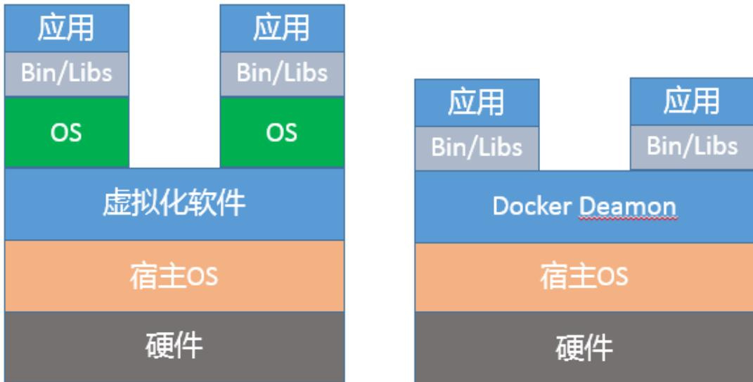
上面的示意图，展示了 Docker 与虚拟机的区别。从技术角度，基于 namespace，Docker 为每个容器提供了单独的命名空间，对网络、PID、用户、IPC 通信、文件系统挂载点等实现了隔离。对于 CPU、内存、磁盘 IO 等计算资源，则是通过 CGroup 进行管理。如果你想了解更多 Docker 的细节，请参考相关[技术文档](#)。
