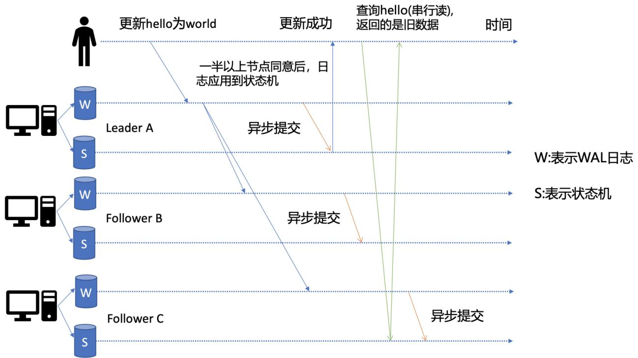
此时若 client 发起一个读取 hello 的请求，假设此请求直接从状态机中读取，如果连接到的是 C 节点，若 C 节点磁盘 I/O 出现波动，可能导致它应用已提交的日志条目很慢，则会出现更新 hello 为 world 的写命令，在 client 读 hello 的时候还未被提交到状态机，因此就可能读取到旧数据，如上图查询 hello 流程所示。
