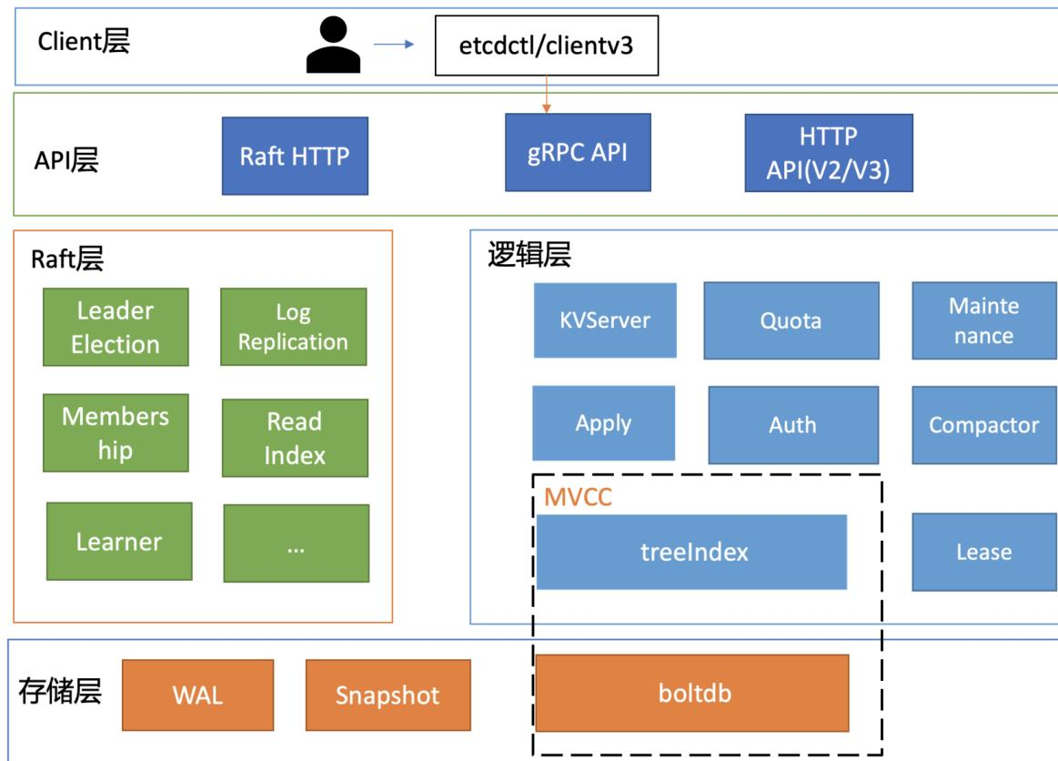
你可以看到，按照分层模型，etcd 可分为 Client 层、API 网络层、Raft 算法层、逻辑层和存储层。这些层的功能如下：
